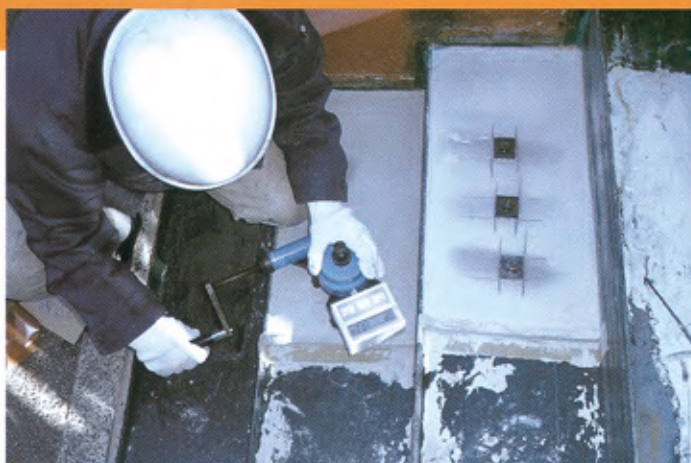
マノールポリマー#1000接着力試験状況
