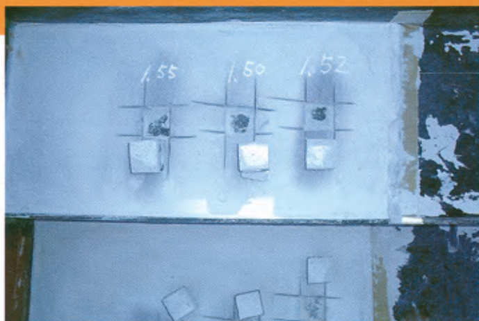
マノールポリマー#1000接着力試験状況
