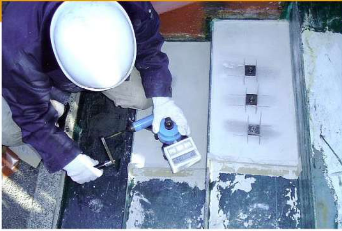
マノールポリマー#1000接着力試験状況
