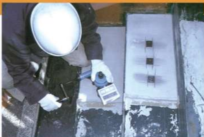
マノールポリマー#1000接着力試験状況
