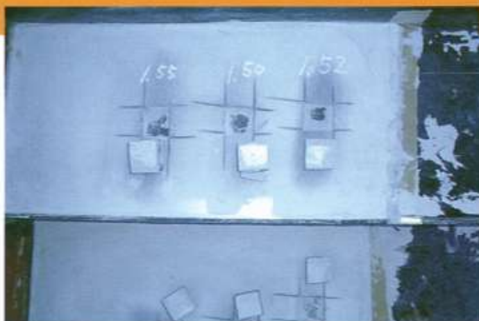
マノールポリマー#1000接着力試験状況
