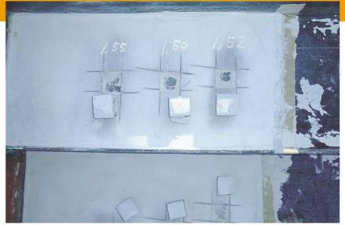
マノールポリマー#1000接着力試験状況
